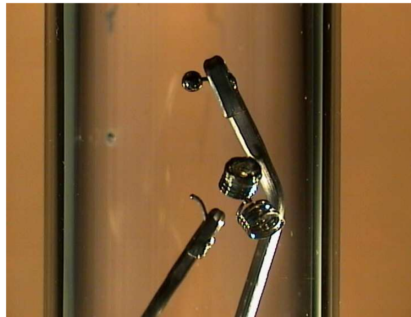
Simulace v laboratoři OSRAM (přepětí 17,7V)
